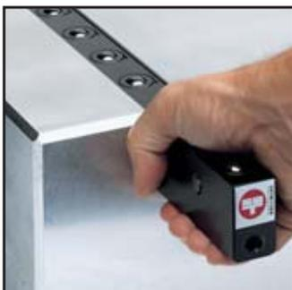
*Barres à billes ROLLBLOC avec raccord hydraulique. Manipulation simple de la serrure de fixation avec clé à six pans creux*
