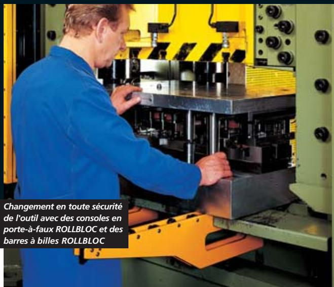
Changement en toute sécurité de l'outil avec des consoles en porte-à-faux ROLLBLOC et des barres à billes ROLLBLOC
