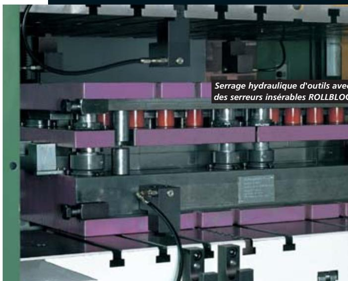
Serrage hydraulique d'outils avec des serreurs insérables ROLLBLOC
