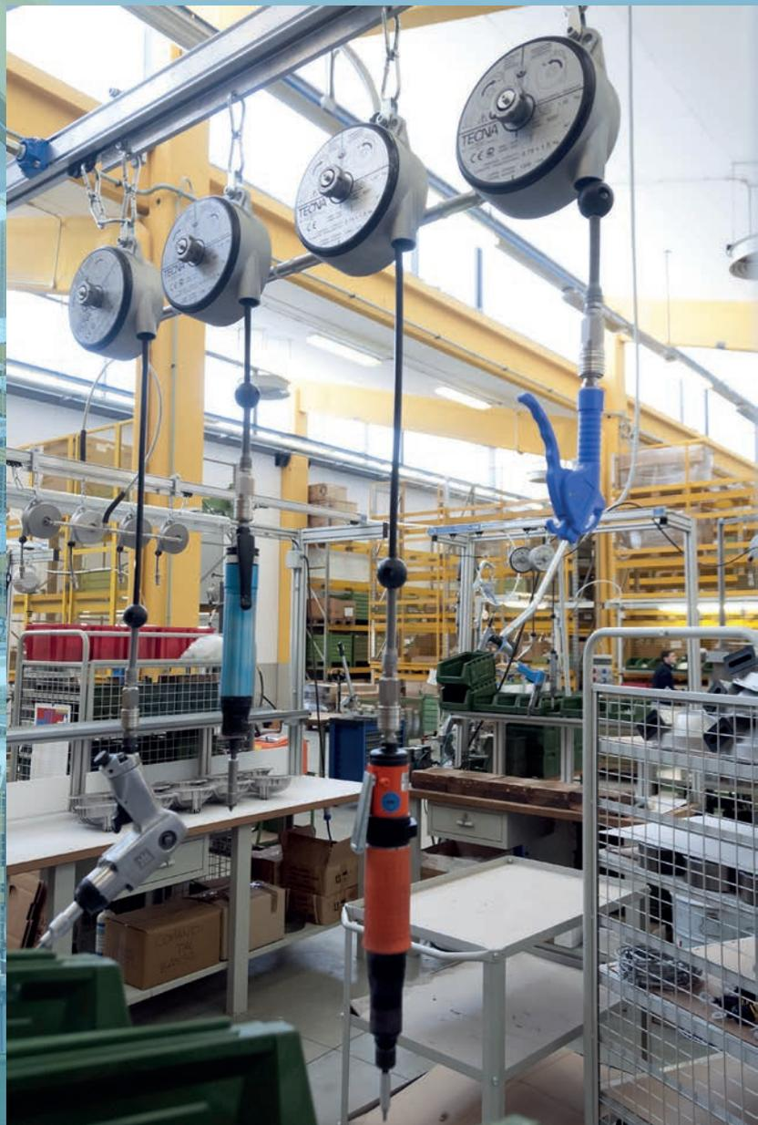
TECNA propose une ligne complète d'ÉQUILIBREURS DE TUYAUX PNEUMATIQUES et d'ACCESSOIRES POUR TUYAUX PNEUMATIQUES, parfaits pour l'équilibrage et le travail ergonomique avec des outils pneumatiques.
